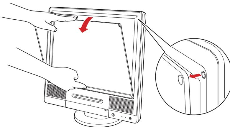
**重要** ● ラスターパネルの落下防止のため、必ずパネルの上下を両手で持って取り外してください。
