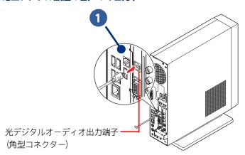
★ラインアウト共用の端子を使用する場合 (地上デジタル放送以外の音声を出力)
