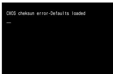
パソコンの内蔵時計などを動かすCMOSバッテリーが消耗したときに表示されるメッセージの例です。
