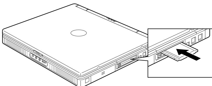
スマートメディアまたはコンパクトフラッシュ、SD カードの場合は、次のように専用の PC カードアダプターに接続してから、PC カードアダプターをパソコンの PC カードスロットに接続する。
