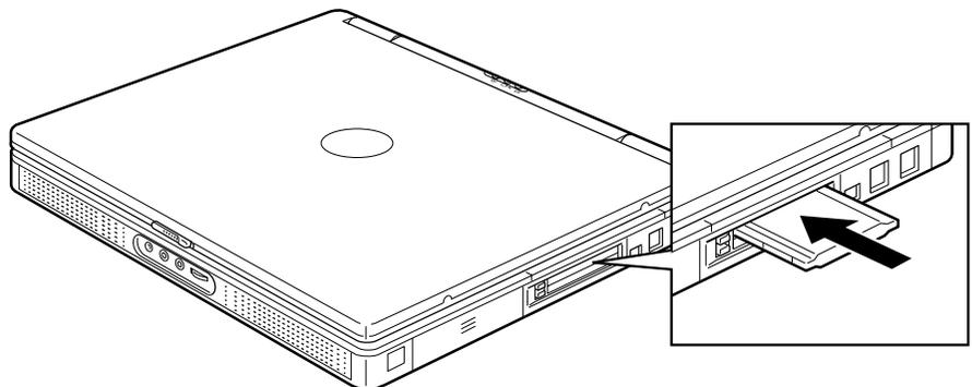
スマートメディアまたはコンパクトフラッシュ、SDカードの場合は、次のように専用のPCアダプターに接続してから、PCアダプターをパソコンのPCカードスロットに接続する。
