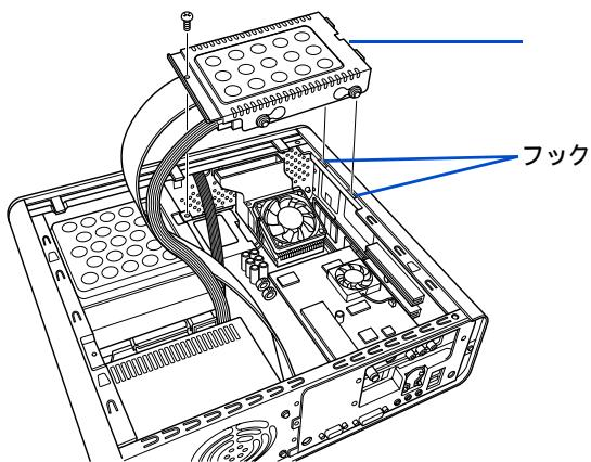
**3** メインボードユニットのネジ×1を外し、引き出し用のフックを倒して指をかけ、ゆっくりと2~3cm手前に引き抜き、コネクタープレート止め金具を倒して外す。
