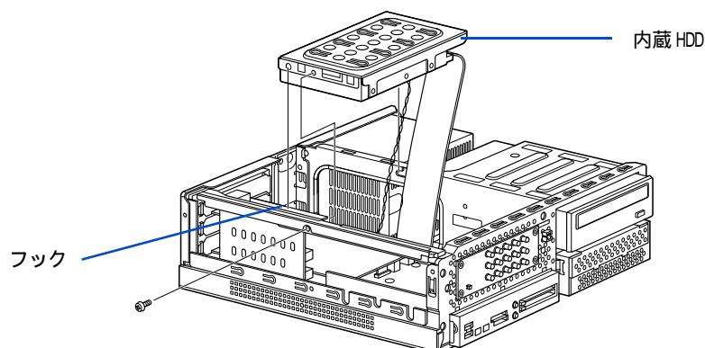
**4** ネジを外し、コネクタープレート止め金具を開く。
