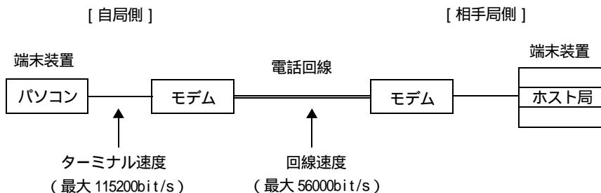
本 FAX モデムを MNP クラス 5 に設定している場合、ホスト局も MNP クラス 5 以上に対応していれば、モデム間で自動的にデータの圧縮をします。その結果、回線速度は 33600bps でも、実際には 33600bps 以上で通信を行ったことになります。通信をスムーズにするため、ターミナル速度は回線速度の 2 ~ 3 倍に設定してください。回線速度とターミナル速度の通信速度差は、モデムのバッファで吸収します。なお、バッファがオーバーフローしないように、通信ソフトとモデムのシリアルポートでフロー制御の設定を行ってください。
