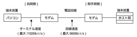
本 FAX モデムを MNP クラス 5 に設定している場合、ホスト局も MNP クラス 5 以上に対応していれば、モデム間で自動的にデータの圧縮をします。その結果、回線速度は33600bps でも、実際には33600bps 以上で通信を行ったことになります。通信をスムーズにするため、ターミナル速度は回線速度の 2 ~ 3 倍に設定してください。回線速度とターミナル速度の通信速度差は、モデムのバッファーで吸収します。なお、バッファーがオーバーフローしないように、通信ソフトとモデムのシリアルポートでフロー制御の設定を行ってください。
